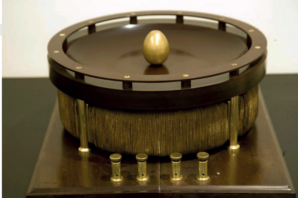
Модел Теслиног индукционог мотора са ротором у облику јајета, тзв. Колумбово јаје
